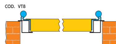
con telaio tubolare a "L" with "L" tubular frame
