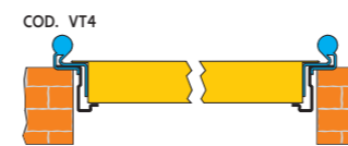
con telaio tubolare a "T" with "T" tubular frame
